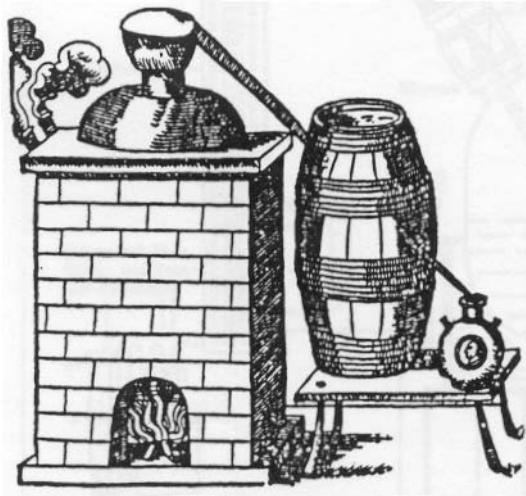
Schnapsbrennengerät mit direkter Feuerung und einem Fass als Kühler; um 1600 (aus Hieronymus Tragus' Kräuterbuch)
